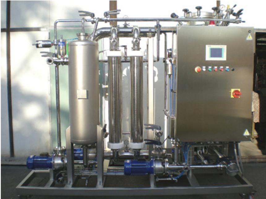
La Fluxa Filtri fornisce impianti per la filtrazione tangenziale con membrane polimeriche a fibra cava. Il sistema automatico, o semi automatico, viene utilizzato sia per vini fermi che per spumanti, e permette di rimuovere lieviti e trattenere parti solide senza andare a interferire o alterare la qualità e gli aspetti organolettici del prodotto trattato. Il campo d'impiego per questo tipo d'impianto va da 2.500 l/h fino a 10.000 l/h e più.
