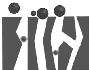
SBARRAMENTO MECCANICO Mechanical Retention Figura 2
